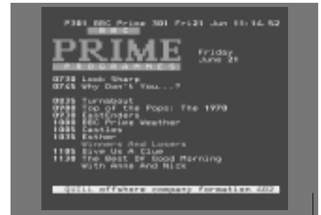
Eine typische Teletextseite. Die aktuelle Seitennummer, der Kanalname, Datum und Uhrzeit erscheinen neben einer dreistelligen Nummer am oberen Bildschirmrand, die den Fortschritt der Seitensuchfunktion anzeigt.
